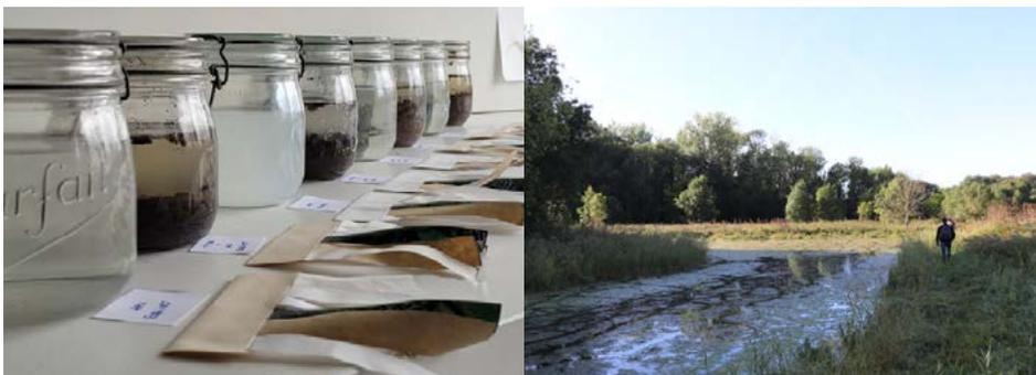
Châteauroux se distingue par un nouvel espace expérimental de traitement des eaux usées situées à proximité de la station d'épuration. Celui-ci se construit autour de plusieurs bassins de collecte et de rétention dans lesquels on utilise les bactéries présentes dans les racines des plantes pour absorber certains polluants comme le nitrate ou les phosphates.
