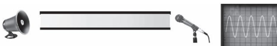
On augmente la fréquence  $f$  du GBF et on relève les fréquences  $f_n$  ( $n = 1, 2, 3, \dots$ ) pour lesquelles la colonne d'air entre en résonance. Pour chaque valeur de  $f_n$ , on entend un son intense, ce qui se traduit par une valeur maximale de l'amplitude du signal aux bornes du microphone.
