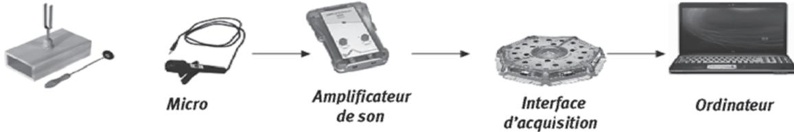
On réalise l'enregistrement d'un son grâce à un système constitué d'un micro + amplificateur + interface d'acquisition + ordinateur. Le signal enregistré est analysé avec un logiciel spécifique. On obtient alors un **spectre dit de Fourier**.
